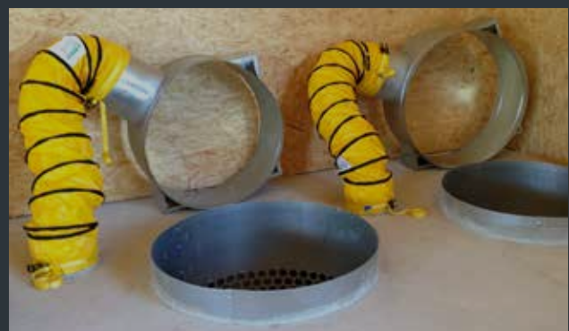
Der Verteilerschlauch versorgt die zweite Reihe mit zusätzlicher Trocknungsluft.
