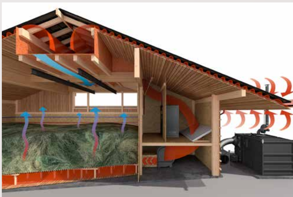
System Trocknen mit Dachabsaugung
