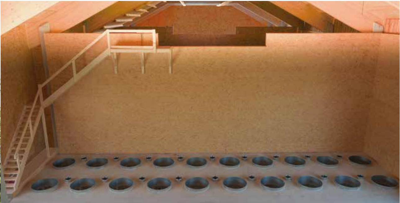
Kombi-Flex Rundballentrocknung mit einer Boxentrocknung.
