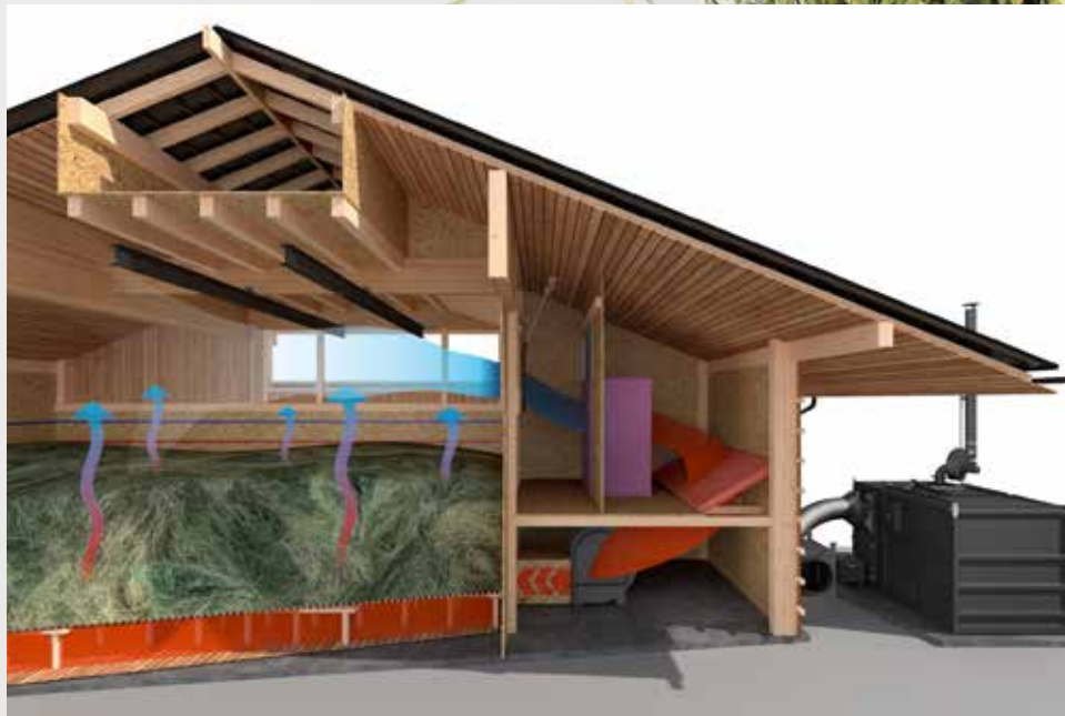
System Trocknen mit Luftentfeuchter (optional mit Heizregister) im Umluft-Betrieb
