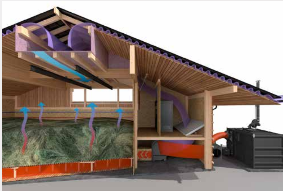
System Trocknung mit Warmluft und Dachabsaugung
