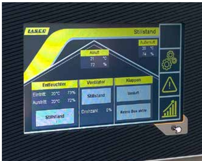
Entfeuchtersteuerung CControl-Plus : Integrierte Trocknungssteuerung mit automatischen Programmfunktionen.
