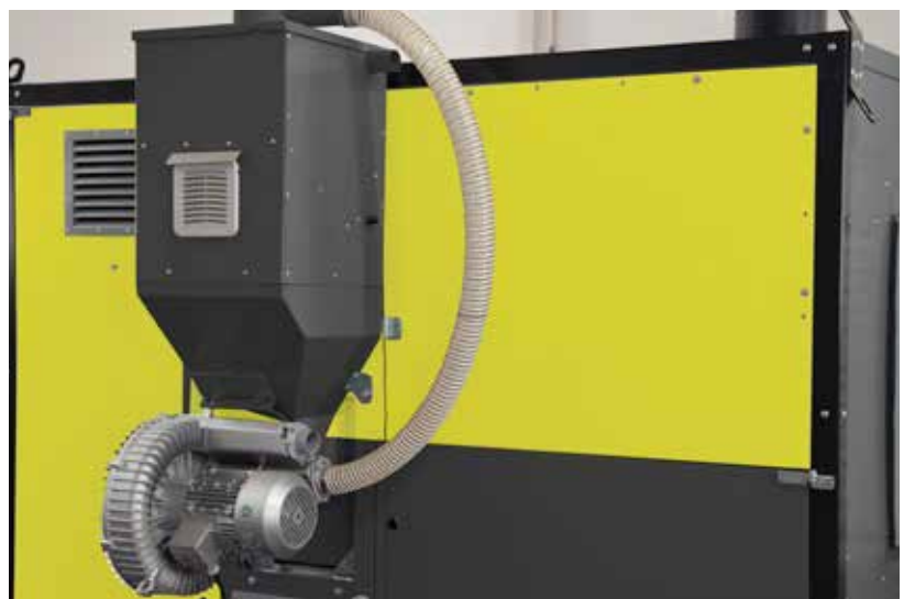
Pelletstundenbehälter mit aufgebauter Hochleistungsturbine zum Pelletssilo.
