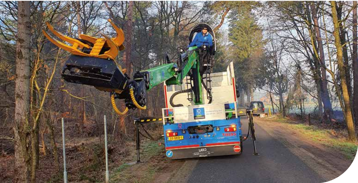
LKW mit GMT035 TTC Fällgreifer und GMT Schnellwechselsystem
