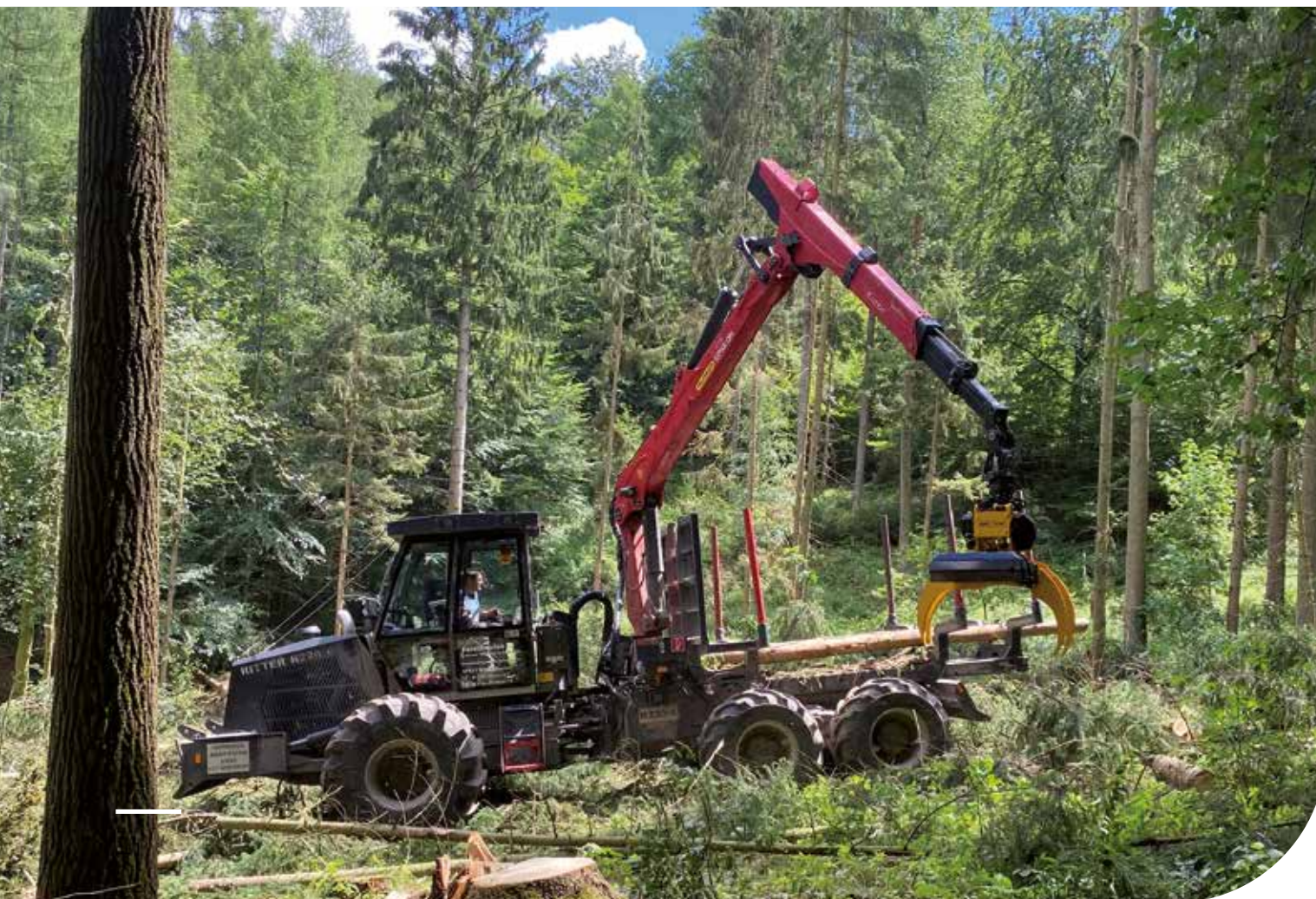
Ritter Skidder mit GMT050 Fällgreifer und GMT C10 Schnellwechselsystem
