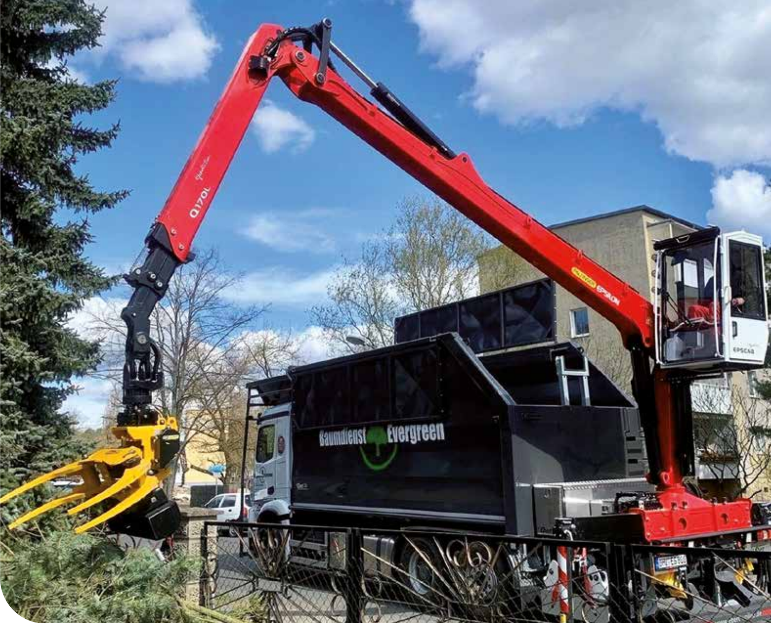
LKW mit GMT050 Fällgreifer und GMT C10 Schnellwechselsystem
