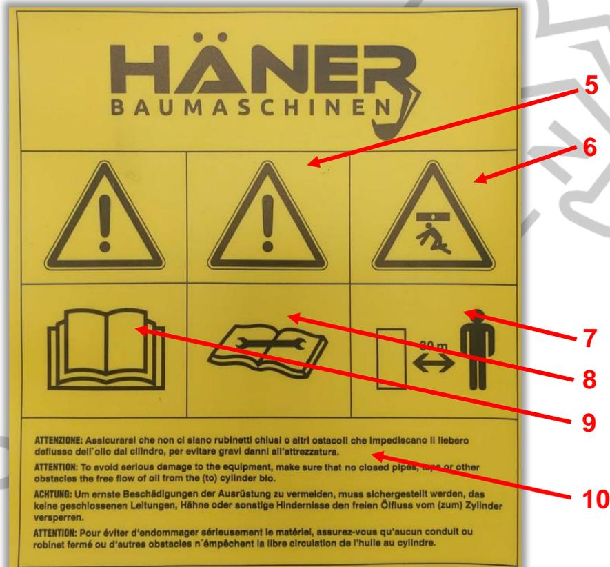
Abbildung 4-2: Beispieldarstellung Warnschild
