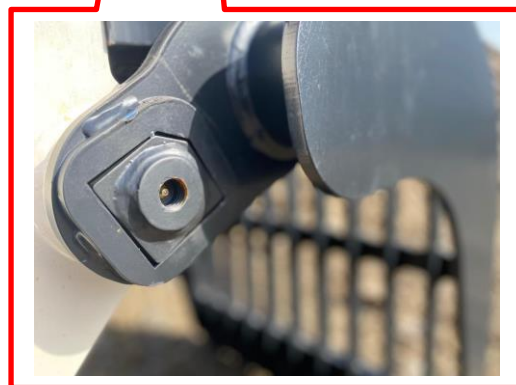
Abbildung 12: Beispieldarstellung Schmierstellen Greifer HAGx-Serie
