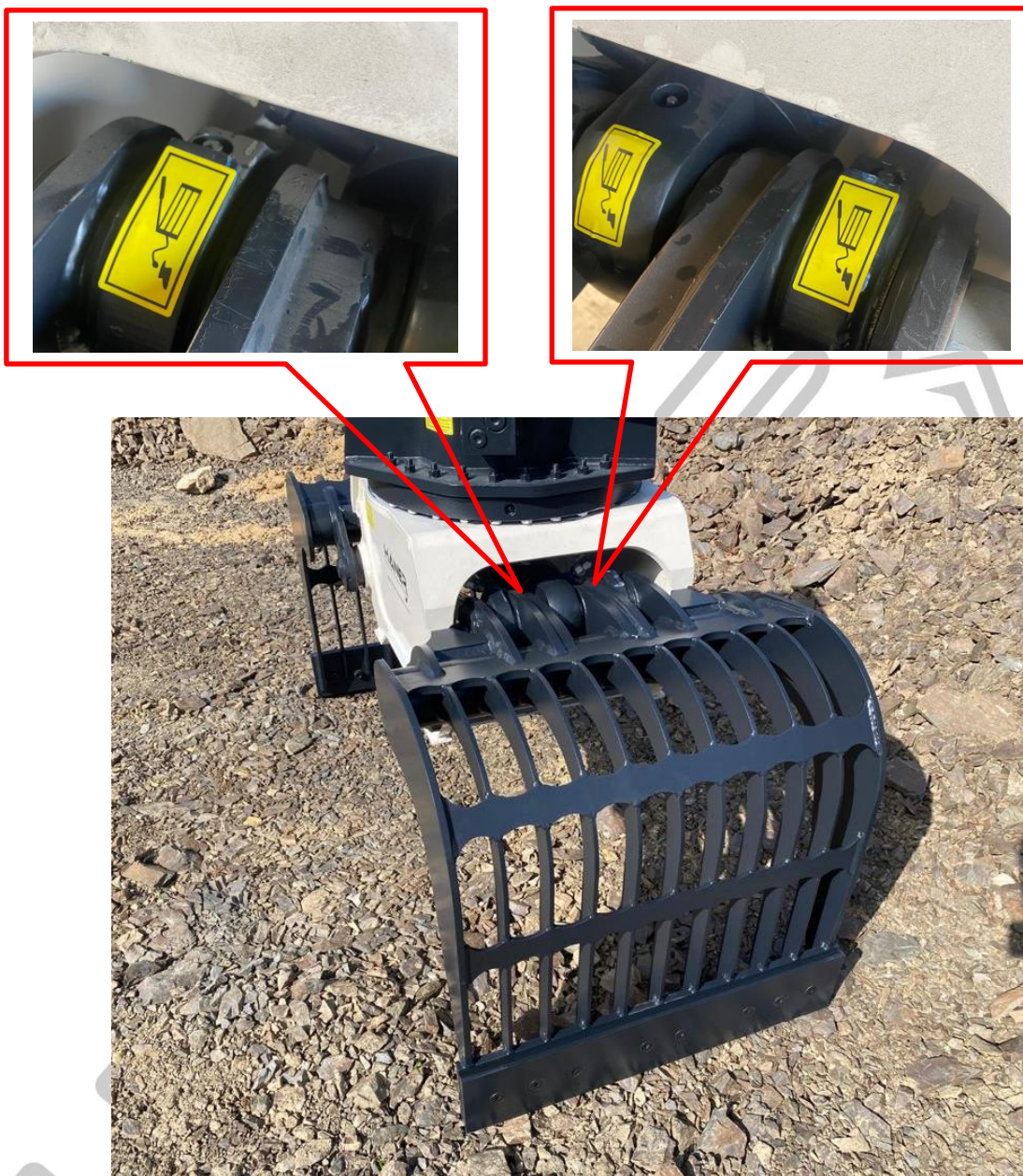
Abbildung 13: Beispieldarstellung Schmierstellen Greifer HAGx-Serie
